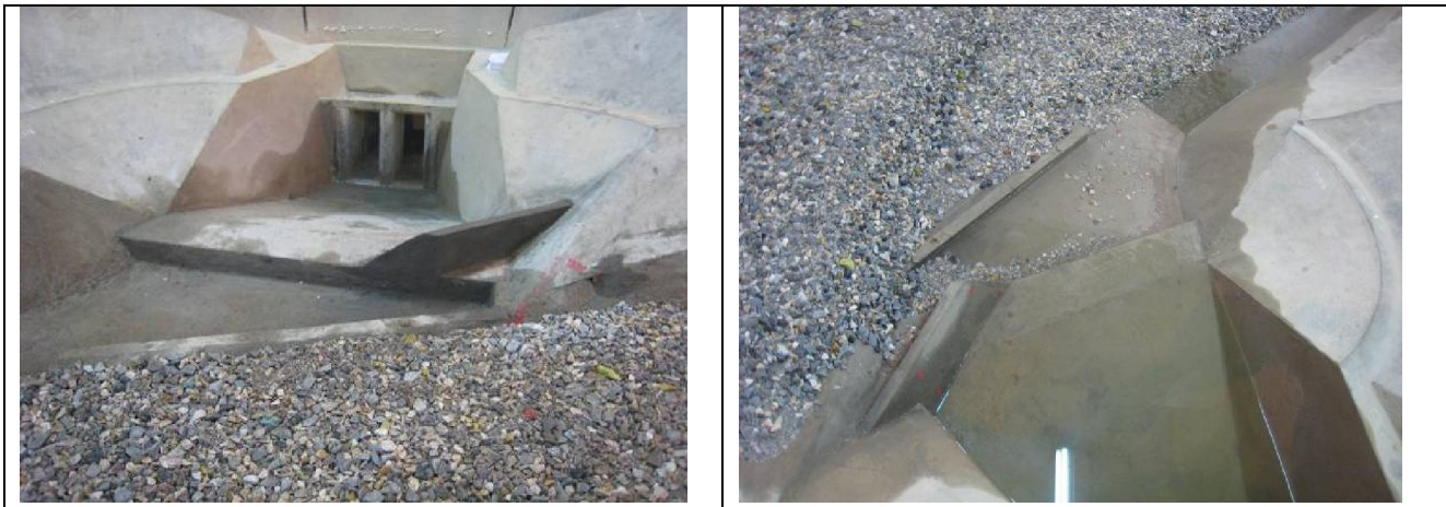
Hình 3: NMTĐ Huội Quang, kết cấu cửa ra không bồi (TNMHTL)
