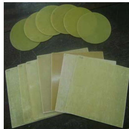
Hình 2. Các mẫu gia công để đo đặc cơ chế của việc khuếch tán nước.
